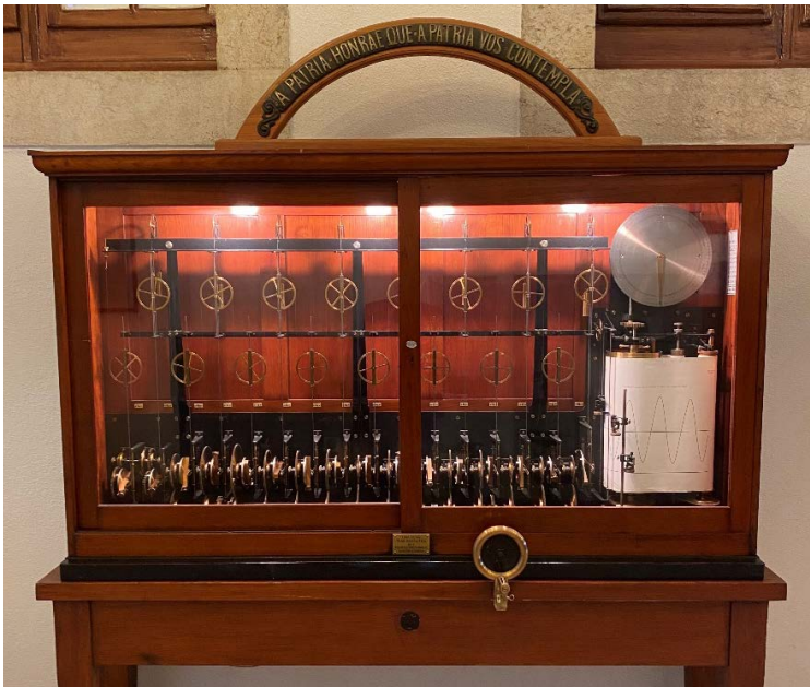
O preditor de marés de Kelvin existente no Instituto Hidrográfico, em Lisboa
